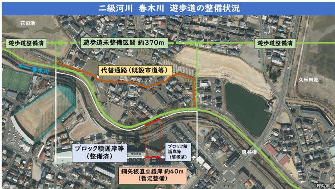
本件について、先日、岸和田土木事務所に伺ったところ、当該区間 370mのうち、330m区間は、用地買収を行いブロック積みによる護岸の整備が完了しているが、残る約 40m区間は、当時、用地買収にご協力いただけなかったことから、平成 17 年に鋼矢板による護岸の暫定整備を行い、当面の治水目標である時間雨量 80 ミリ程度の降雨に対する安全性を確保していること、また、河川の近くを通る市道等を代替通路とすることで、遊歩道の連続性を確保していることをお聞きしました。
